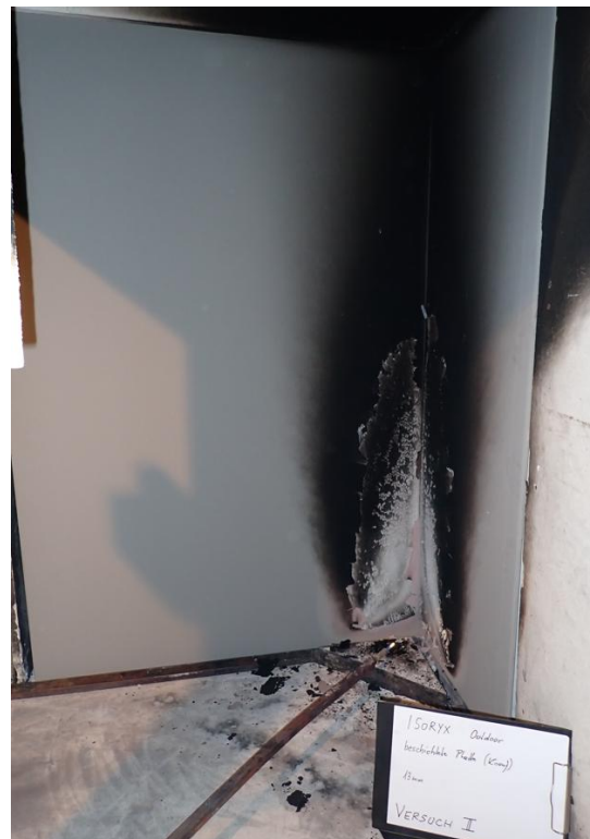
Bild 8: Prüfkörper nach der Prüfung, Gesamtansicht
