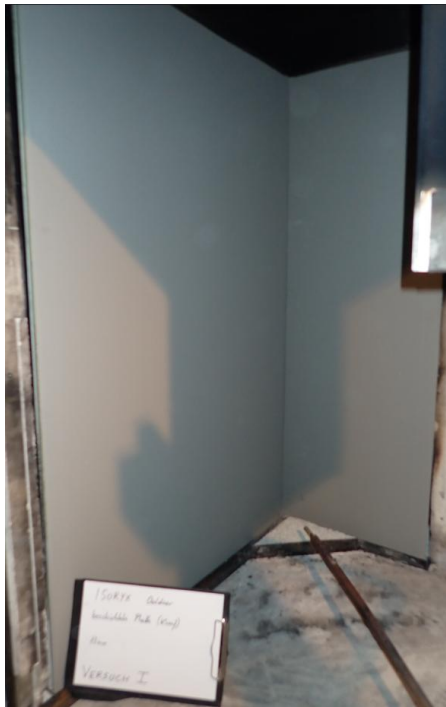
Bild 1: Prüfkörper vor der Prüfung, Nahaufnahme der Außenkante
