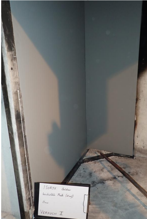
Bild 5: Prüfkörper vor der Prüfung, Nahaufnahme der Außenkante
