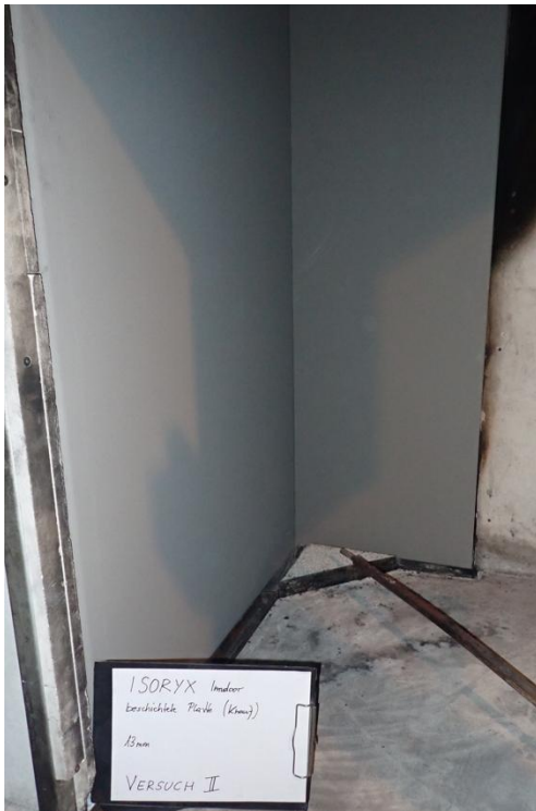
Bild 5: Prüfkörper vor der Prüfung, Nahaufnahme der Außenkante
