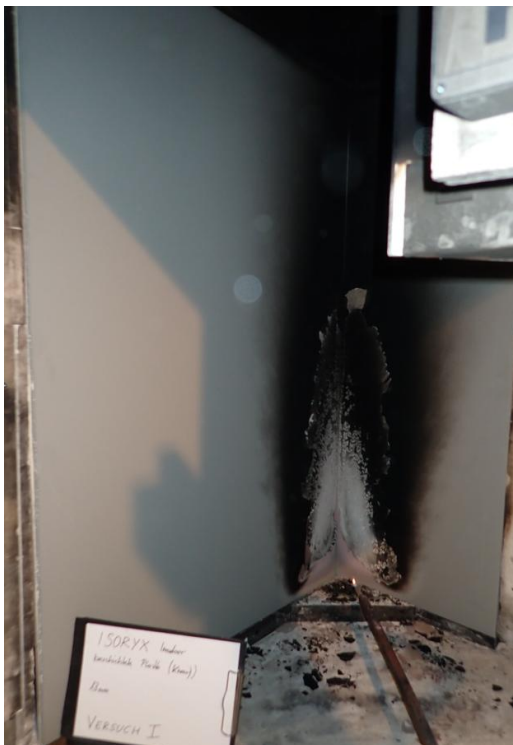
Bild 3: Prüfkörper nach der Prüfung, Nahaufnahme der Außenkante
