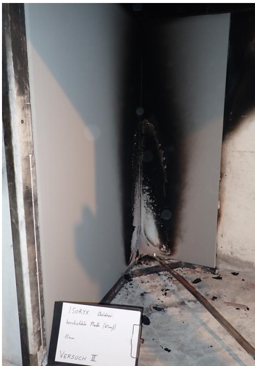
Bild 11: Prüfkörper nach der Prüfung, Nahaufnahme der Außenkante
