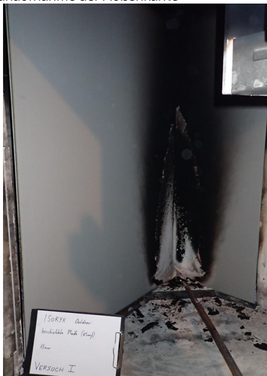
Bild 3: Prüfkörper nach der Prüfung, Nahaufnahme der Außenkante
